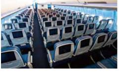
新しいワイヤレス機内エンターテイメントシステムを搭載した最初のワイドボディ機材となります。高速2Kuインターネット接続を装備し、iMessage、WhatsApp、Facebookメッセンジャーのテキストメッセージを無料で送受信することができます。すべての座席に、形状記憶機能つきクッションが内蔵され、ユニバーサル電源とUSBポート、飛行中の状態に合わせて照明が変わるLEDアンビエント照明、広々とした頭上の荷物棚、業界随一のコンテンツを誇る機内エンターテインメント「デルタ・スタジオ」を無料で楽しめる高解像度スクリーンを設置。また、最新のロールスロイス社製エンジン「トレント7000」を搭載し、前世代の航空機に比べて25%以上燃料消費率を改善しました。
